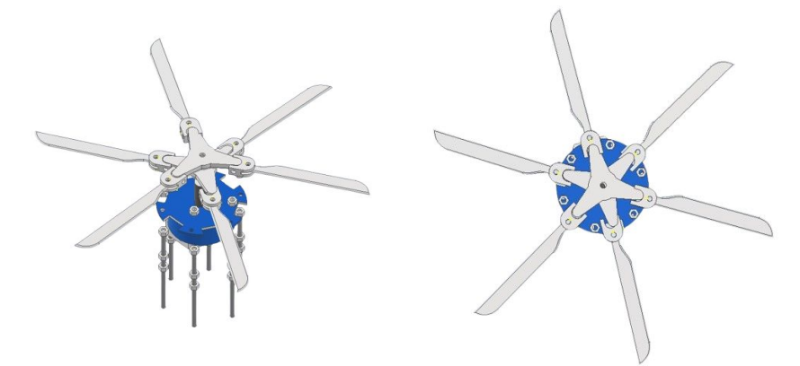
Fig. 44.3: Diseño del autogiro en modelo CAD.
